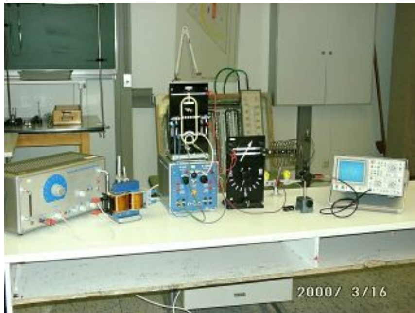
Abbildung 4.5: Versuch zur Amplitudenmodulation: links der Sinusgenerator mit Koppeltransformator, in der Mitte der Röhrengenerator, rechts die Empfangsspule mit Oszilloskop
