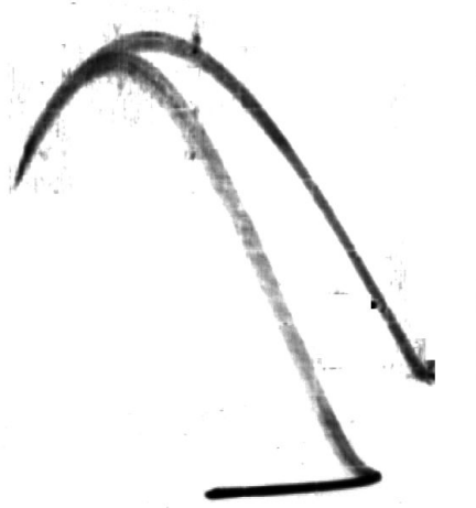
Abbildung 5: Poincare-Schnitt bei V_s = 6,3V
