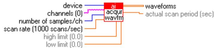
Abbildung 2.5: Acquire Waveforms
